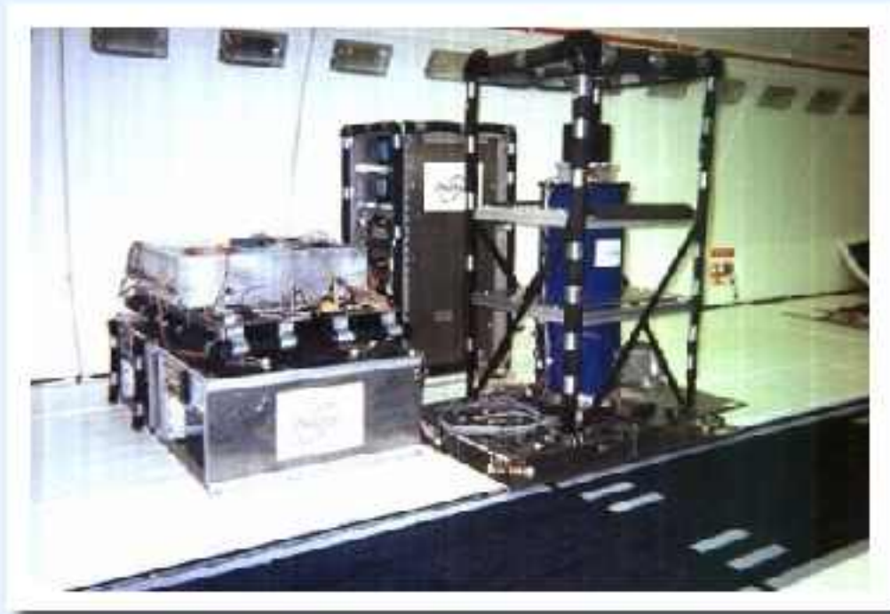
PHARAO: L'horloge à atomes froids pour expériences en micro-gravité
